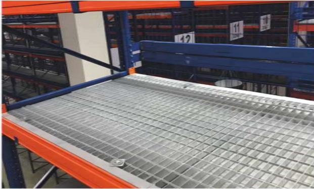
Ein charakteristisches Bauteil dieses Produktes ist die **Randeinfassung**, die für Positionierung und Stabilität der auf bzw. Zwischen den Kragarmen platzierten Fachbodenmodule sorgt. Als Randeinfassung kann ein Blechprofil dienen, dessen Höhe die des Gitterrostes oder des L-förmigen Winkels (optional des U-Profiles) übersteigt.
